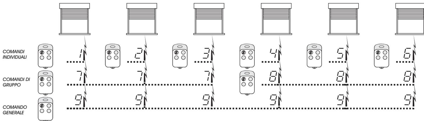
Come si vede dall'esempio, le sei tapparelle sono comandate singolarmente dai canali da 1 a 6 del trasmettitore (comandi singoli), i canali 7 e 8 comandano ciascuno un gruppo di tre tapparelle (ad esempio quelle appartenenti alla stessa stanza), e il canale 9 comanda tutte le sei tapparelle (comando generale).
