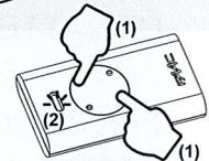
**E)** Rimettere in appoggio frontalmente, led con led, il radiocomando originale FAAC con quello De Nardi e premere sul radiocomando originale(1) il tasto da programmare.
