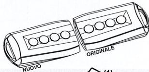
**C)** Premere sul radiocomando originale(1) il tasto da programmare e rilasciarlo non appena il led del radiocomando che si intende duplicare non sarà a luce fissa(2).
