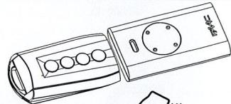
**C)** Premere sul radiocomando originale FAAC(1) il tasto da programmare e rilasciarlo non appena il led del radiocomando De Nardi sarà a luce fissa(2).
