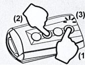
**B)** Mettere in appoggio frontalmente, led con led, il radiocomando originale FAAC con il radiocomando De Nardi da programmare.
