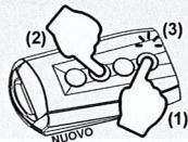
**B)** Mettere in appoggio frontalmente, led con led, il radiocomando originale con quello che si intende duplicare.
