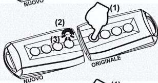
**D)** Allontanare il radiocomando da duplicare e premere contemporaneamente(1) sul telecomando originale i tasti 1 e 3 fino a quando il led lampeggerà velocemente(2).
