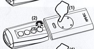
**D)** Allontanare il radiocomando originale FAAC e premere contemporaneamente(1), sullo stesso, i tasti a croce fino a quando il led lampeggia(2).
