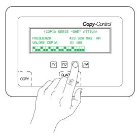
Per la serie "ONE" tenere ad una distanza di 10-20 cm il radiocomando dal copy-control, e successivamente tenere premuto il pulsante P3 per trasmettere il codice da copiare. Si consiglia di leggere attentamente il manuale tecnico del radiocomando utilizzato.
