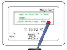
Posizionare il radiocomando come in figura vicino alla zona "quartz and low frequency". Tenere premuto un tasto del radiocomando quarzato. Con un cacciavite ceramico agire lentamente e delicatamente sul potenziometro che regola l'antenna fino a massimizzare l' indicatore di potenza che compare sul display. Una volta raggiunto il valore massimo allontanare leggermente il radiocomando e ripetere l'operazione fino a raggiungere il massimo valore visualizzabile sul display.
