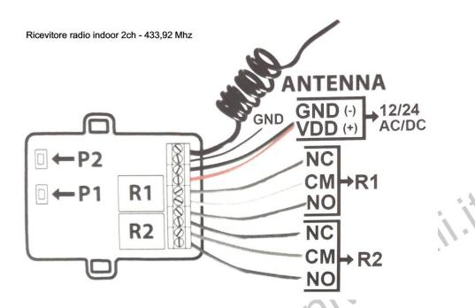
Massima corrente di carico sul relè: 12A 14 VDC o 7A 120 VAC
