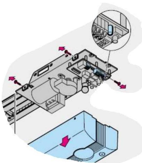
1- Premere due secondi il tastino trasparente "P" sotto il motore Ecostar. Il led lampeggia lentamente.
