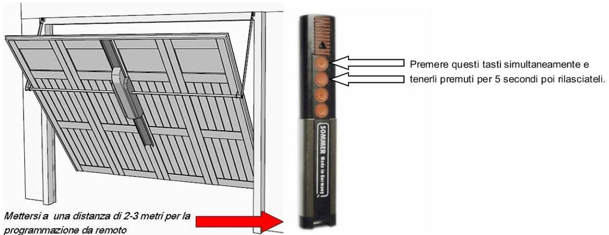
**Importate:** Prima di iniziare la programmazione verificate che vostro telecomando abbia i tasti perfettamente funzionanti, in oltre, si consiglia per la buona riuscita della programmazione, di sostituire la batteria sul vecchio telecomando. Modello della batteria: litio 3v CR2032
