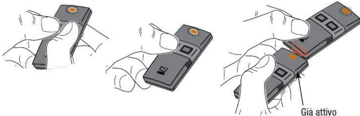
Quando il telecomando sarà memorizzato, il led lampeggerà per 3 volte. Ora potete uscire dalla programmazione rimettendo tutte le levette in OFF.
